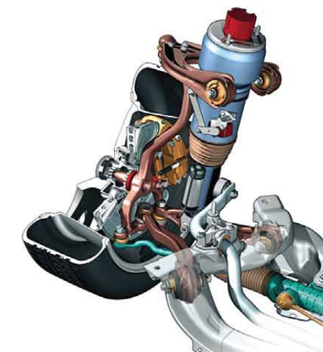
Пневмоподвеска и активные амортизаторы – очень частое и эффективное сочетание
